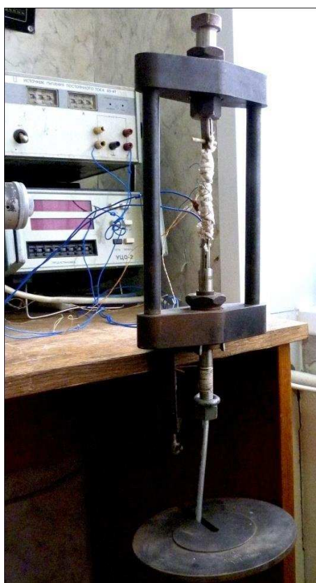
Рис. 1. Устройство для определения теплопроводности материалов при осевом нагружении растягивающей силой
