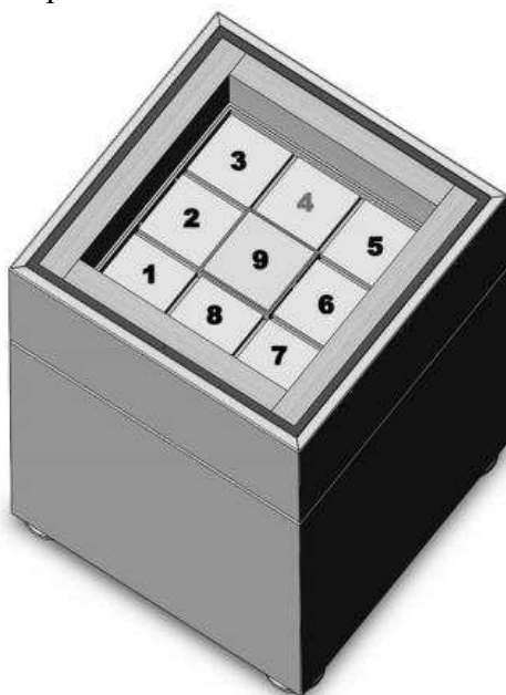
Рис. 2. Схема расположения нагревателей в стенде
