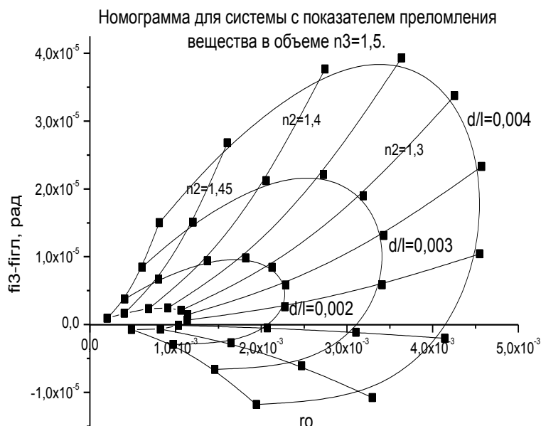
Рис.1 Номограмма ( \Delta\varphi - \rho ) для определения ПП n_2 и толщины слоя d/\lambda ( \lambda = 6328 \text{ \AA} ) Радиальные линии – линии равных n_2 . Огибающие - линии равных толщин d/\lambda
