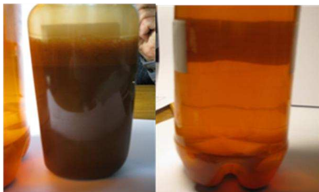
а б Рис. Фотография хладоносителя до регенерации (а) и после регенерации (б)
