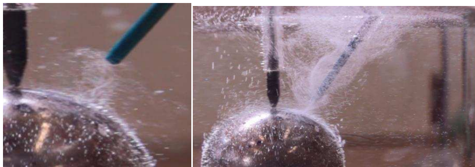
Рис. 1. Визуализация вихревого движения в электропроводной жидкости: а) – начальная стадия вихреобразования через 5 сек после пропускания тока через электролит; б) – развитое вихревое движение через 25 сек. Подаваемое напряжение 25 В, измеряемая сила тока 0.1 А, индукция магнитного поля, создаваемого намагниченным шаром, 1.3 Тл
