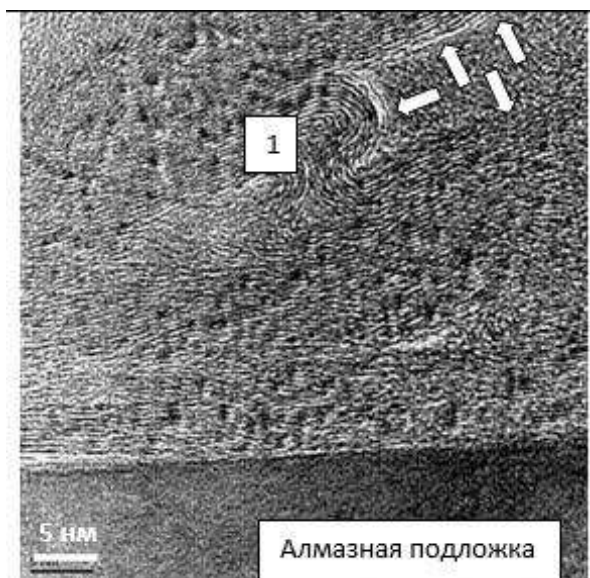
Рис. 1. Результат прохождения фронта плавления по частице графита: стрелки – фронт плавления, 1-затвердевшее вязкотекучее состояние графита
